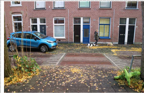
차량속도 저감 유도를 위한 고원식 횡단보도 설치
