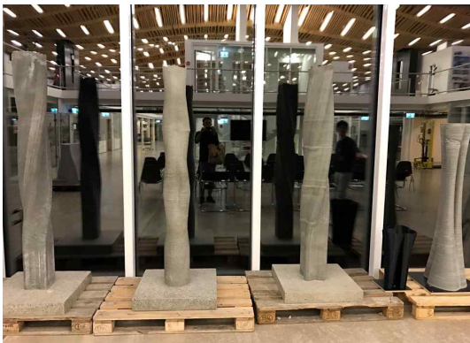
3D 프린팅으로 제작된 비정형 콘크리트 기둥(목업) (NEST 빌딩에 실제 적용)
