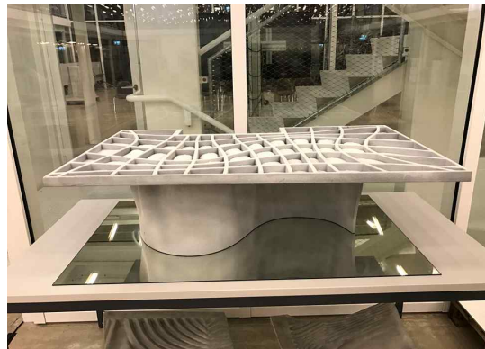
3D 프린팅으로 제작된 콘크리트 슬래브와 벽체(목업) (NEST 빌딩에 실제 적용)
