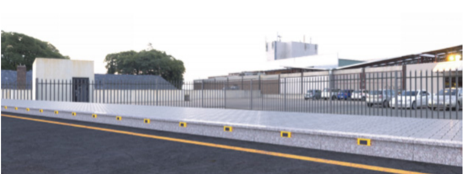
[그림 5-85] 경계석 LED 조명 설치 사례
