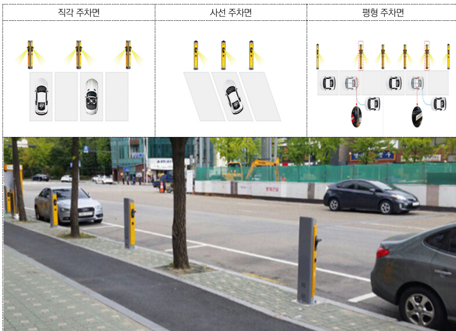
[그림 5-86] 주차면별 통합관리시스템 설치 예시
