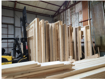
[그림 4-12] 패널의 공장 제작 및 현장 조립 예
