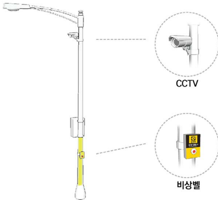
[그림 5-62] CCTV 설치 예시
