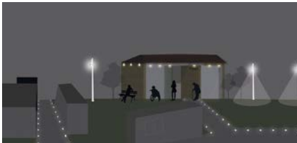
[그림 5-38] 마을쉼터 바닥조명 양쪽 설치 예시
