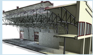
그림 3-12, 13 FARO사의 건설정보 수집용 레이저 스캐너와 BIM 정보로 연동한 3D모델링
