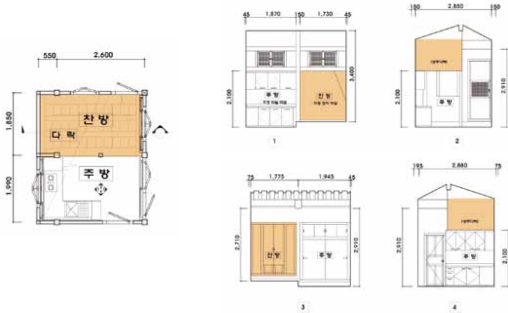
[그림 3-21] 주방과 찬방 평면도 및 전개도
