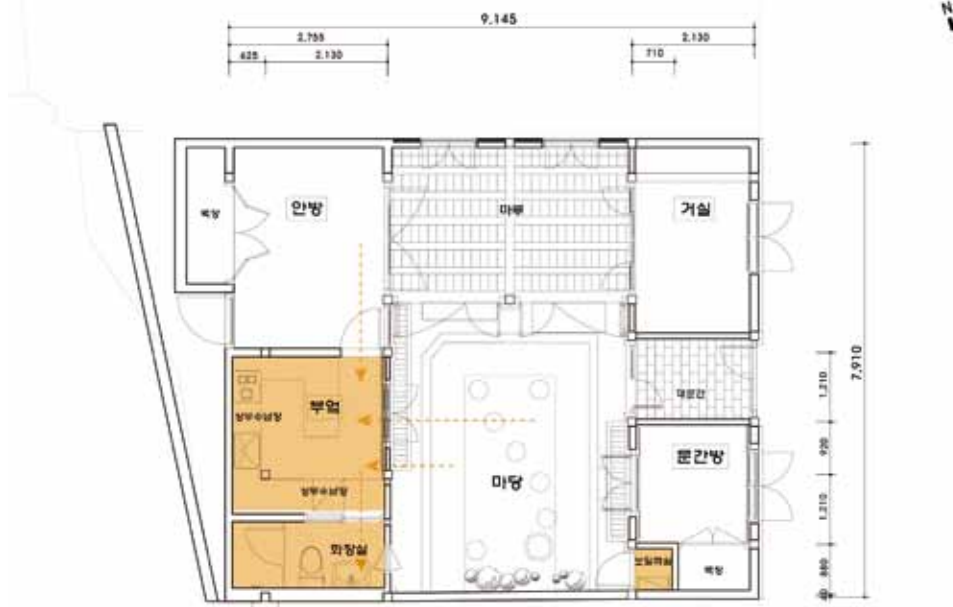
[그림 2-21] 리모델링 평면도(2005년)
