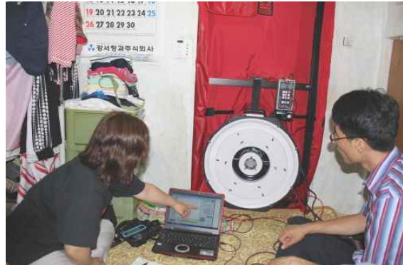
[그림 3-8] 두꺼비하우징 집수리 모습(좌)과 에너지진단 모습(우) (자료 : 인터넷 은평시민신문(2011.7.25일자))
