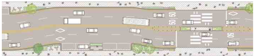
[그림 2-3] 차로폭 다이어트 유형2(포켓주차 및 시게인, 내민보도, 중앙보행섬 설치)
