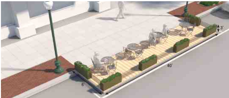
[그림 2-18] 파클렛 설치 예시
