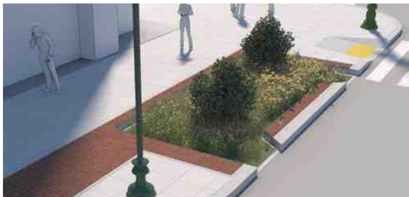
[그림 2-17] 여과기능을 하는 식생형 시설물(Biofiltration Swales)
