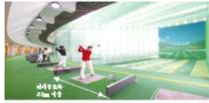
[그림 4-25] 타석유효폭 확보 (칸막이 너비 제외한 유효폭 2.5m 이상)
