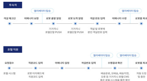
[그림 3-20] KT AI 호텔 로봇의 주요 기능 및 이동 시나리오
