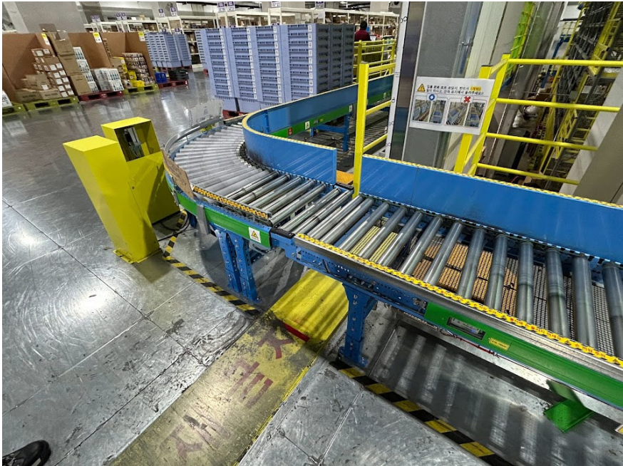
[그림 2-40] 방화셔터가 통과할 수 있는 적층 랙 및 컨베이어 벨트 시스템 사례
