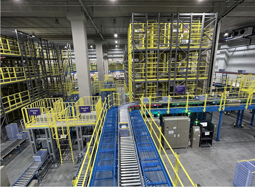
[그림 2-12] 자동창고 및 컨베이어 시스템 설치 사례
