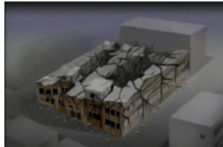
[그림 2-15] 청주우암상가 붕괴과정그래픽 출처: 국가기록원 기록정보(각주25)
