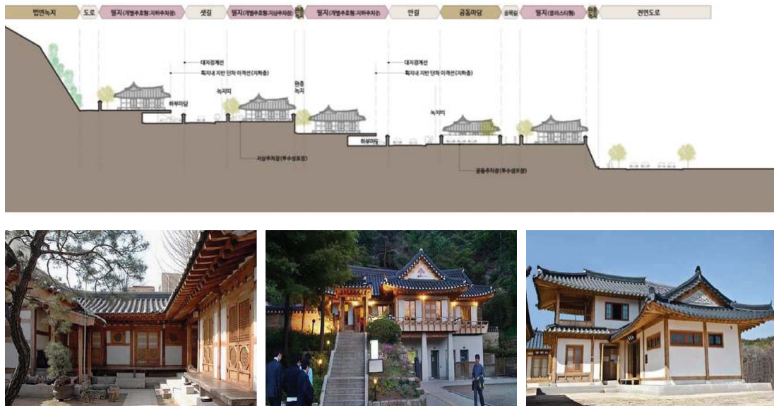
[그림 4-9] 세종시 한옥마을 대지 높낮이 및 건축물 용도에 따른 허용 층수 예시 (출처: 행정중심복합도시건설청(2016.6), 1-1, 1-3 생활권 지구단위계획 시행지침 이미지(p.250, p.254) 편집)
