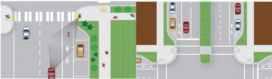
[그림 5-4] 교차부 보도확장을 통한 운전자 가시성 확보(좌) 및 노상주차 허용(우)
