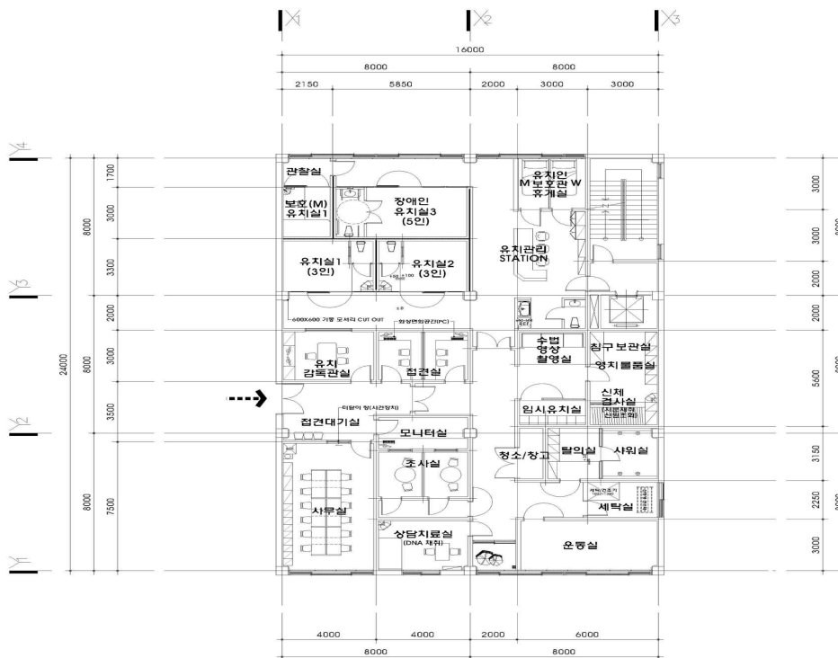
[그림 1] 일반 유치장 평면도: 유치장 설계 표준규칙 별도 3
