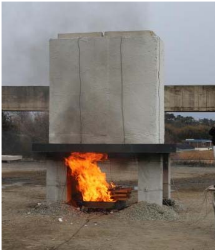
[그림 4-10] 화재확산방지용 캔틸레버 적용사례 (출처: 한방유비스(주) 내부자료)
