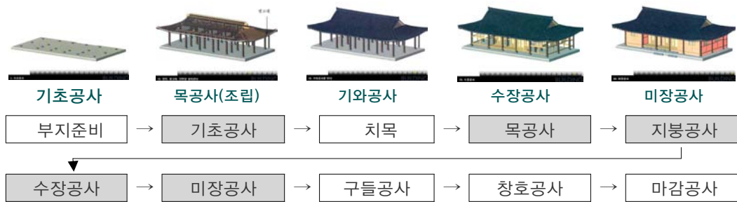
[그림 6-1] 한옥 표준시공 work flow ※ 이미지 출처 : 전라남도 (2006), 「한옥 시공 매뉴얼」 v.1.
