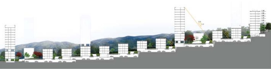
[그림 2-8] 건축물 인동간격 완화에 따른 A3블록 주동 단면도
