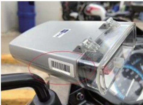
자동차(상)와 오토바이(하)에 설치된 IU 출처: 싱가포르 육상교통청 One Motoring 홈페이지. https://onemotoring.lta.gov.sg/content/onemotoring/home/driving/ERP/ERP.html
